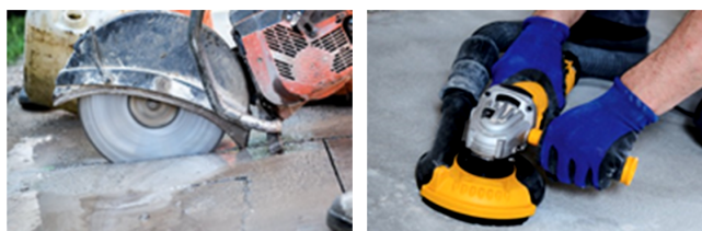
Machine avec système d'abattage à l'humide
