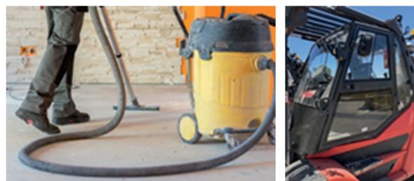
Engins équipés de cabine climatisée et pressurisée à air épuré
